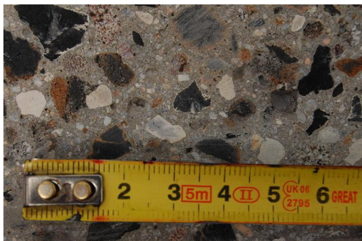
Obrázek 1.: Struktura betonu s černouhelnou hlušinou
