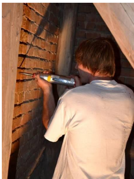
Obrázek 7.: Zjišťování pevnosti v tlaku zdících prvků pomocí tvrdoměru Schmidt LB.
