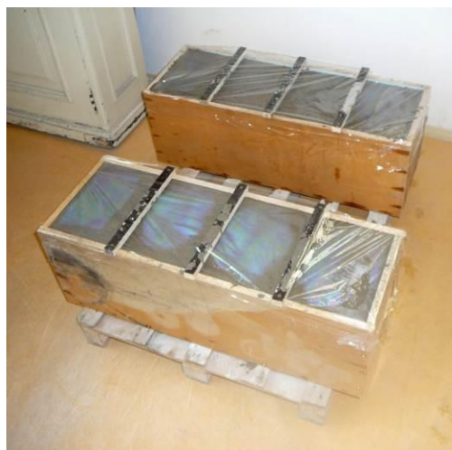
Obrázek 4.: Uložení kvádrů po betonáži.
