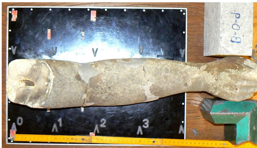
Obrázek 3.: Radiografie pískovcové ruky od ramene k zápěstí v geometrii 1, pohled od rentgenky (z ohniska prozařování)
