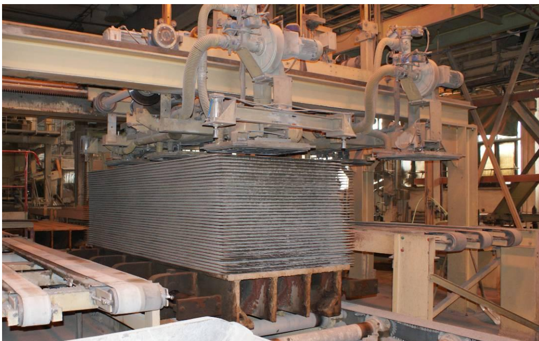
Obrázek 2.: Výroba cementotřískových desek
