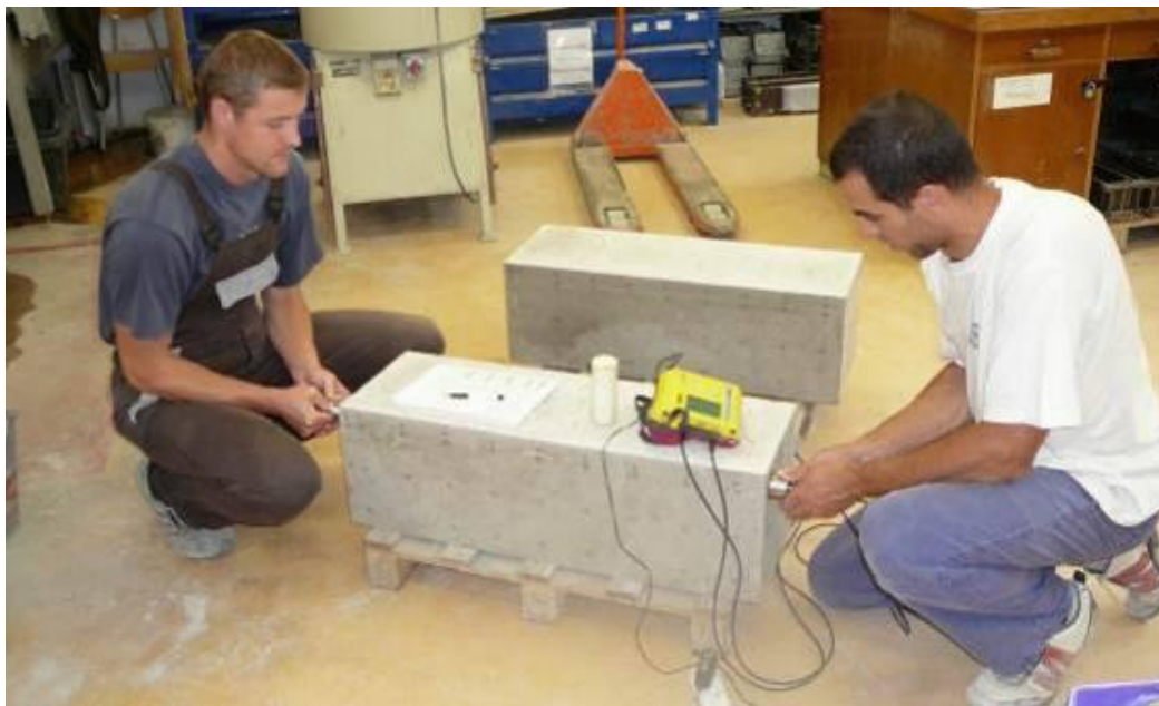
Obrázek 6.: Měření doby průchodu UZ impulsů kvádrem – podélně.
