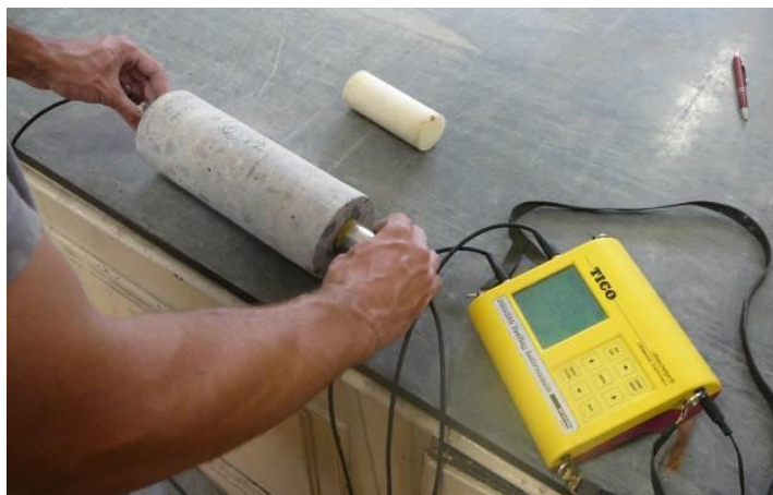
Obrázek 4.: Měření dynamického modulu pružnosti ultrazvukovou metodou.
