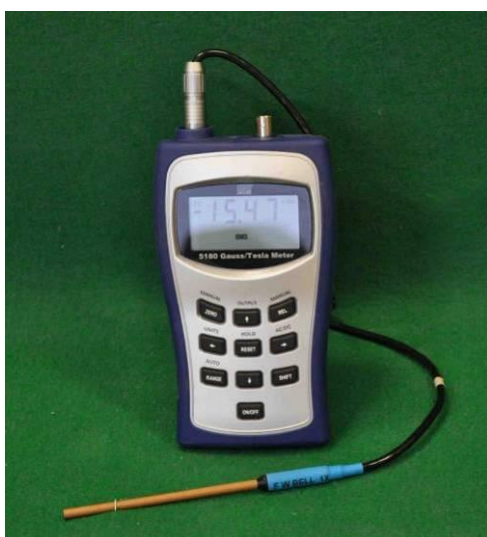
Obrázek 2.: Gauss-teslameter Bell 5180 s radiální Hallovoú sondou
