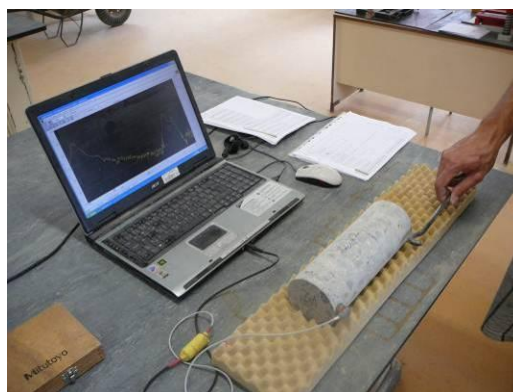
Obrázek 6.: Měření dynamického modulu pružnosti rezonanční metodou z vlastních frekvencí příčného kmitání.
