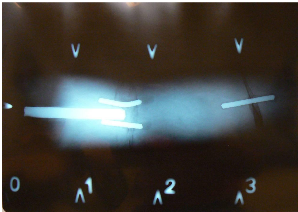
Obrázek 4.: Radiogram pískovcové ruky od ramene k zápěstí - dobře patrné jsou kovové spojovací prvky v obou místech lomu (v lokti a polovině předloktí) i původní výztuž končící v lokti. Na snímku jsou dobře vidět i předvrtané otvory pro vložení spojovacích prvků v místech lomů. Je patrný i otvor, v němž je uložena původní výztuž, vyplněný sírou.
