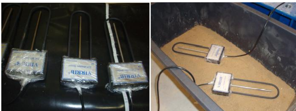
Obrázek 8 a 9.: Snímače vlhkosti VIRRIB pro sledování vlhkostních rozdílů zhutněného podloží vozovky
