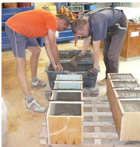
Obrázek 3.: Výroba betonových kvádrů.
