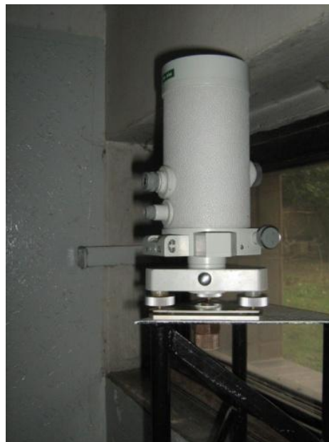
Obr. 1 Optický prevažovač Zeiss PZL 100
