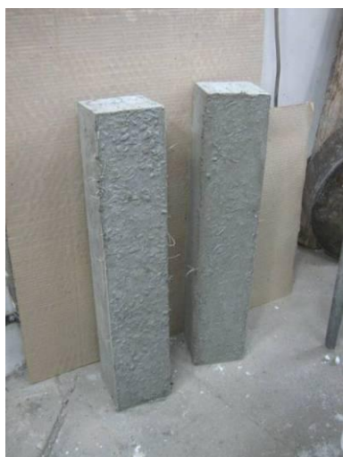
Obrázek 1.: Základní tělesa o rozměrech 150/150/700 mm
