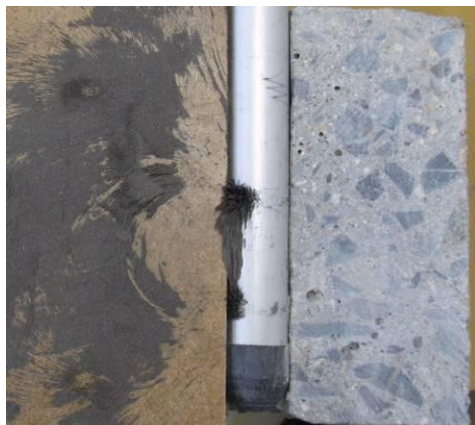
Obrázek 1.: Zobrazení magnetického pole v okolí sondy pomocí ocelových pilin
