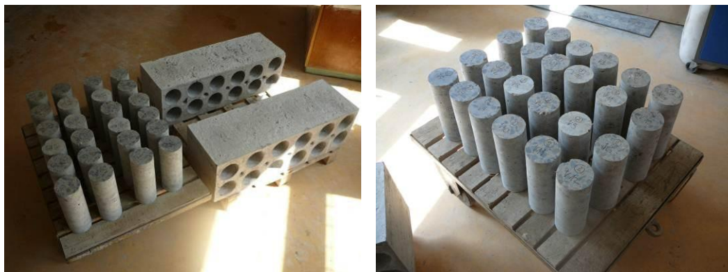
Obrázek 2.: Betonové kvádry s odvrtanými vývrty a samostatné zkušební vzorky.
