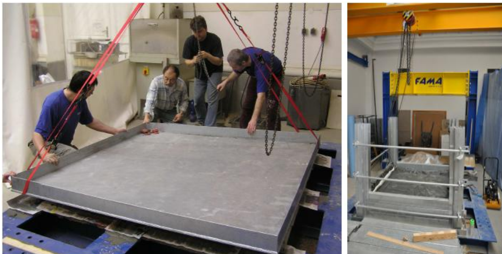
Obrázky 6 a 7.: Pokládání nerezové vany a stavu po zhutnění první technologické vrstvy
