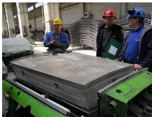
Obrázek 2.: Odbedněný vláknobetonový klenák
