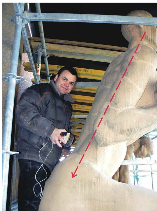
Obrázek 2: Znárodnění zjištěného průběhu ocelové výztuže v plastice č. 4.
