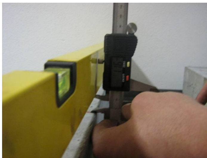
Obrázek 4.: Měření průhybu zkušebního tělesa
