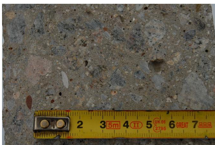
Obrázek 2.: Struktura betonu s přírodním kamenivem
