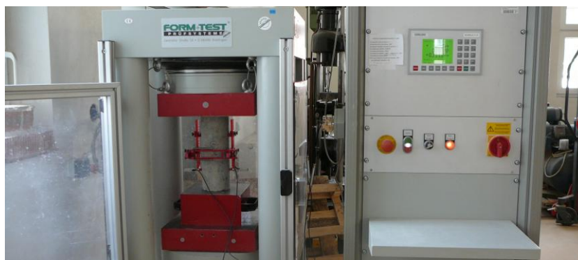
Obrázek 7.: Měření statického modulu pružnosti E_c .
